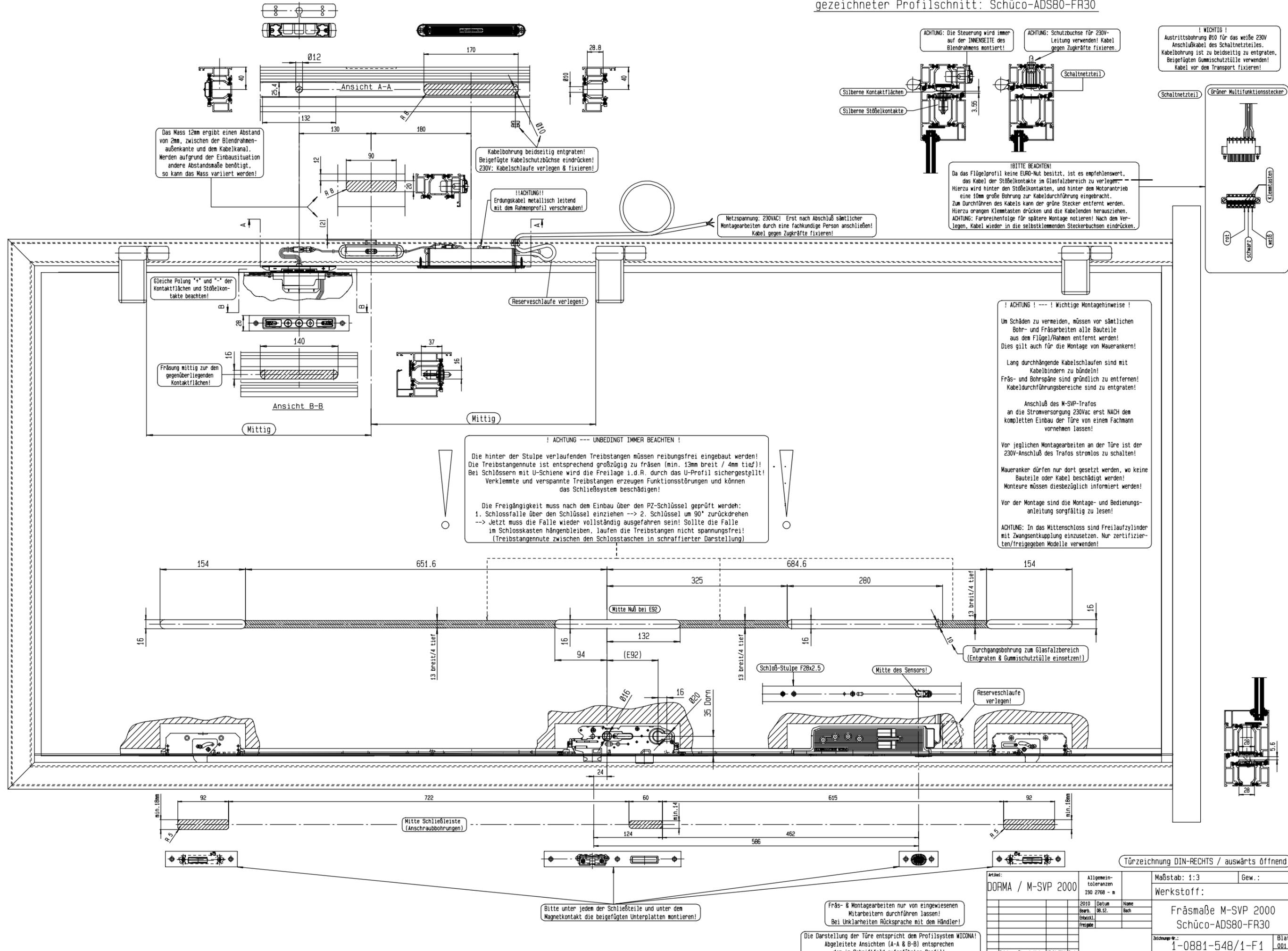
Das Mass 12mm ergibt einen Abstand von 2mm, zwischen der Blindrahmenaußenkante und dem Kabelkanal. Werden aufgrund der Einbausituation andere Abstandsmaße benötigt, so kann das Mass variiert werden!
