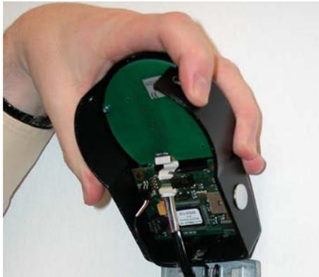
10. Chiudere la cassa sulla base, contemporaneamente tirare il cavo di connessione con molta attenzione in direzione interno cassaforte, lasciando un pò di cavo di riserva.
