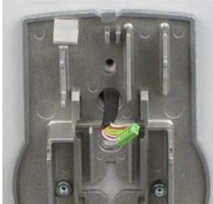
6. Inserire lo scomparto batterie. Guidare il cavo di connessione delle batterie tramite scarico della trazione nello scomparto batterie e nella base. **Fare attenzione a non schiacciare il cavo!**
