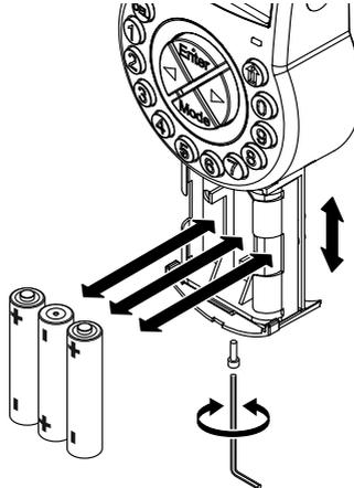
1. Rimuovere la vite dello scomparto batterie posizionata nella parte bassa dell'unità d'ingresso.
