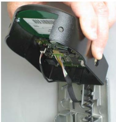
8. Guidare il cavo di connessione delle batterie nel morsetto delle batterie a 2-poli ed il cavo di collegamento nel morsetto serratura a 6-poli. **Verificare la posizione corretta delle spine prima del collegamento. Non forzare eccessivamente per l'inserimento, ma assicurarsi che la connessione sia corretta.**
