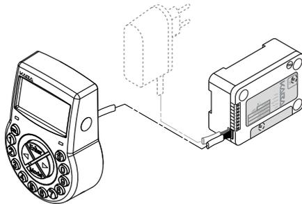
Nella sua versione standard la serratura elettronica Axessor IP funziona a batterie e consiste in: unità d'ingresso, la serratura ed il cavo di connessione. La serratura comprende 2 ingressi e 2 uscite (specifiche → *Connessioni esterne a pagina 24*). Come opzione si può collegare un'alimentazione esterna (6VDC/500mA) ad una delle prese „X1“ o „X2“.
