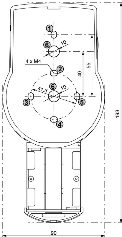
2. Fare 3 fori  $\text{Ø}3.2 \times 14$  mm ed il foro per passaggio cavo  $\text{Ø}10$  mm. Rimuovere sbavature. Fare il filetti M4 i 3 fori.
