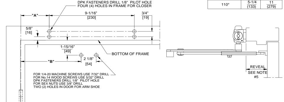
FOR 1/4-20 MACHINE SCREWS USE 7/32" DRILL & TAP
