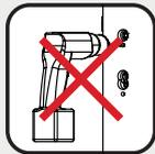
Bei Beschlagsmontage nicht durch das Schloss bohren.
