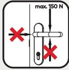
Das Fluchttürschloss der Serie 127/PA hält bei Blockierung der Paniknuss einem Drehmoment von maximal 15 Nm (das entspricht 150 N aufgebracht im Abstand von 100 mm von der Drückerlagerung) stand. Bei größeren Drehmomenten, kann es zu Deformationen der Schlosskinematik kommen!
