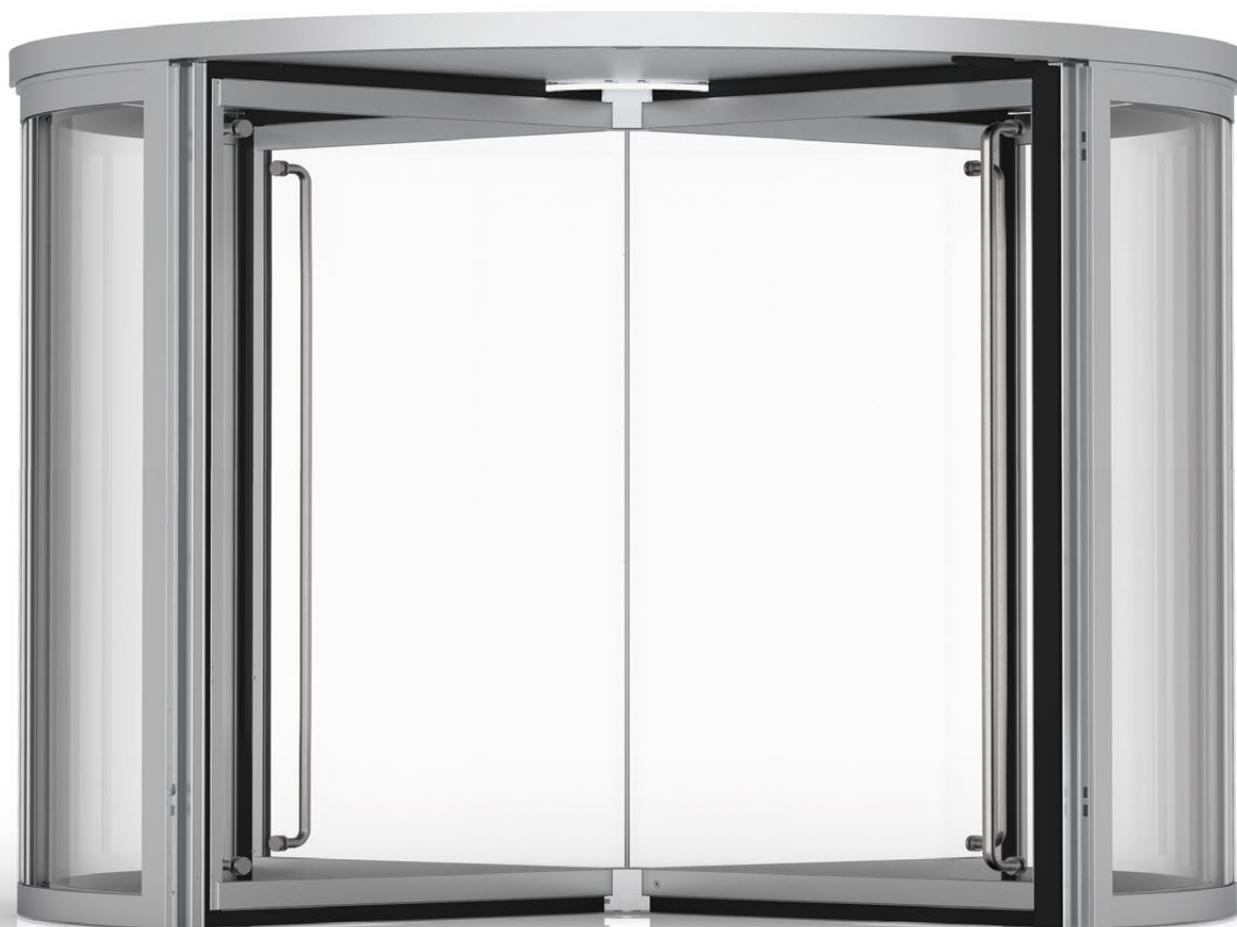
Le porte girevoli KTV di dormakaba si distinguono per il loro caratteristico ciellino piatto di soli 100 mm di spessore con anello luminoso LED integrato. Nonostante le dimensioni ridotte è possibile persino una combinazione con blocco elettromeccanico integrato e chiusura notturna aggiuntiva. L'azionamento diretto poco soggetto all'usura KT FLEX Direct è in grado di resistere ad un'elevata frequenza di passaggio dei visitatori,
