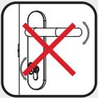
Der Schlüssel muss nach dem Abschießen abgezogen werden! Drücker und Schlüssel dürfen nicht gleichzeitig betätigt werden, da es sonst zu Störungen der Fluchttürfunktion kommen kann!
