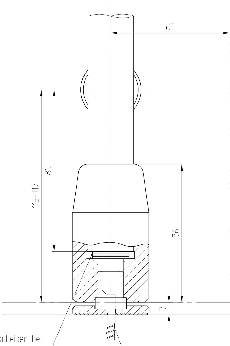
Kunststoffscheiben bei Bedarf unterlegen, um mögliche Bautoleranzen auszugleichen
