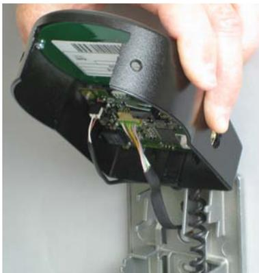
8. Branchez le câble des piles sur le connecteur de la pile à 2-pole et le câble de connexion sur le connecteur de la serrure à 6-pole. **Vérifiez l'orientation correcte des connecteurs avant d'effectuer la connexion. Enfichez sans trop de force, veillez plutôt à effectuer un raccordement soigné.**
