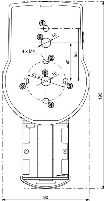
2. Percez les 3 trous de fixation  $\text{Ø}3.2 \times 14$  mm et le passage de câble  $\text{Ø}10$  mm. Ebavurez. Taraudez 3 fois à M4.
