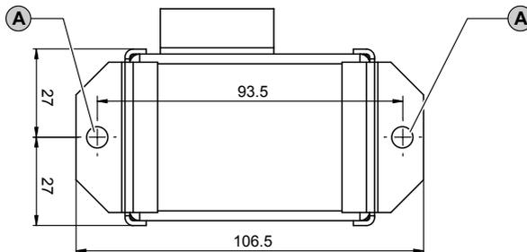
2. Percez les trous de fixation  $\varnothing 5\text{mm}$ . Ebavurez. Taraudez à M6.
