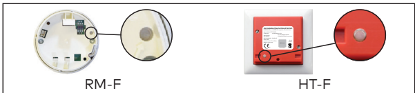
Abb. 1 Die Eingabetasten an den Funkteilnehmern
