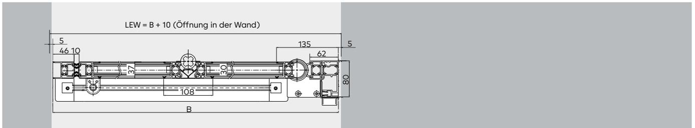
Einseitig öffnend:  $B = LW + 219^*$   $B \text{ min} = 1059 \text{ mm}$  (1119 mm bei Fluchtweg) /  $B \text{ max} = 1459 \text{ mm}^*$
