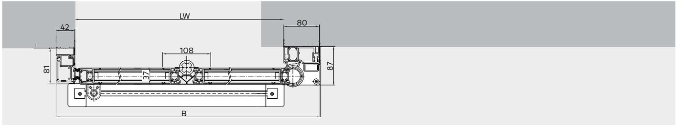
Einseitig öffnend:  $B = LW + 188^*$  B min = 1028 mm (1088 mm bei Fluchtweg) / B max = 1428 mm\*
