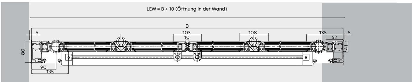
Beidseitig öffnend:  $B = LW + 334^*$   $B \text{ min} = 1314 \text{ mm}$  /  $B \text{ max} = 2814 \text{ mm}^*$
