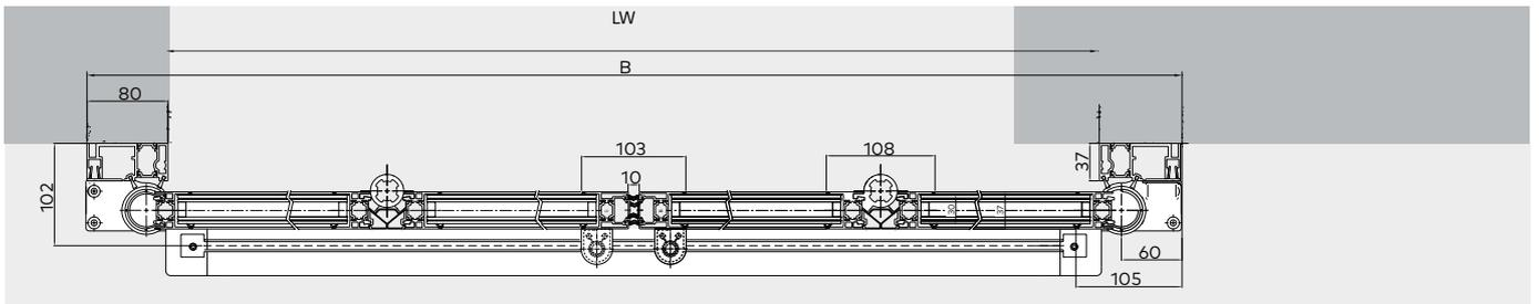
Beidseitig öffnend:  $B = LW + 280^*$  B min = 1260 mm / B max = 2760 mm\*
