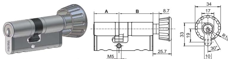
M1419A mit Drehknopf traditionell + Frontabdeckung in Zylinder-Farbe
