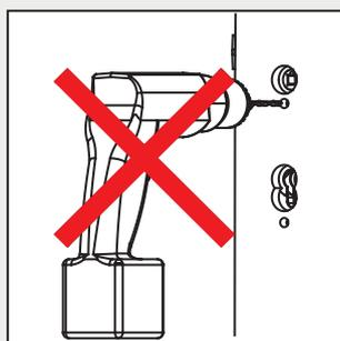
Bei der Montage der Beschläge darf nicht durch das Schloss gebohrt werden, sondern es ist von beiden Seiten der Tür zu bohren!
