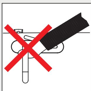
Das Türblatt darf nicht am Türdrücker getragen werden da Verformungen an der Schlossnuss und am Schloss auftreten können!
