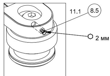
11.1 Регулировка расположения точечных креплений
