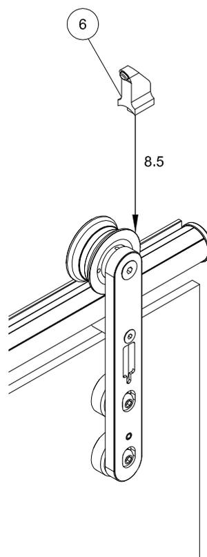
8. Установка дверных стопоров:
