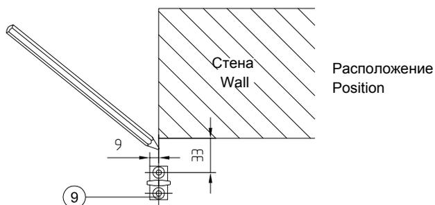
**7. Установка напольной направляющей:**
