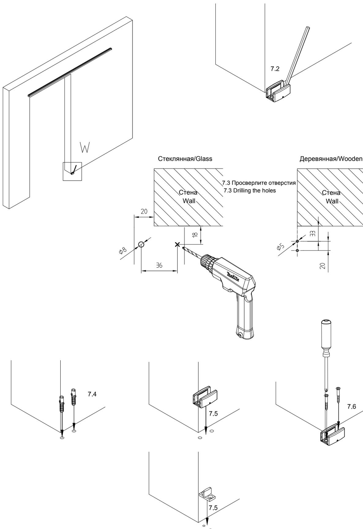
**8. Установка дверных стопоров:**
