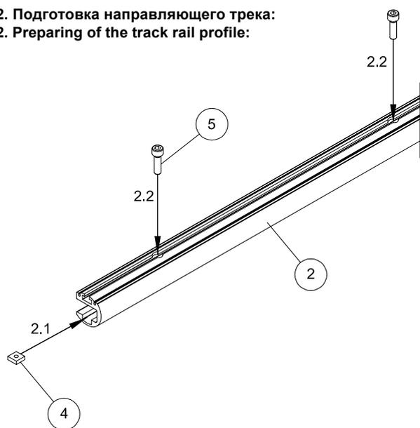
2.2 Затяните винты на 1 оборот в отверстие на профиле!
