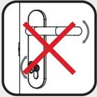
Der Schlüssel muss nach dem Abschließen abgezogen werden! Drücker und Schlüssel dürfen nicht gleichzeitig betätigt werden, da es sonst zu Störungen der Fluchttürfunktion kommen kann!
