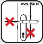
Das Fluchttürschloss der Serie 132/PA mit Fluchttürfunktion B und D hält bei Blockierung der Paniknuss (die Paniknuss ist mit der Nicht-Paniknuss über einen Hebel verbunden) einem Drehmoment von maximal 15 Nm (das entspricht 150 N aufgebracht im Abstand von 100 mm von der Drückerlagerung) stand. Bei größeren Drehmomenten, kann es zu Deformationen der Schlosskinematik kommen!
