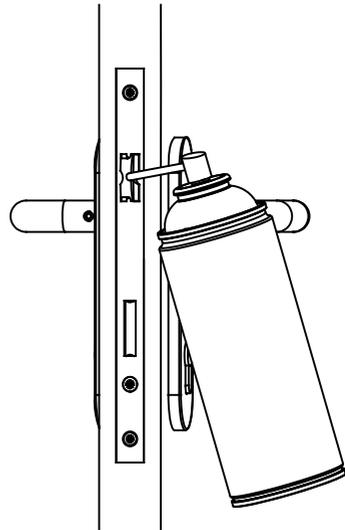
Mindestens 1x jährlich muss am Fallenkopf, zur Aufrechterhaltung und Gewährleistung der Funktion sowie zur Verminderung des Schließgeräusches, ein geeignetes Schmiermittel aufgetragen werden.
