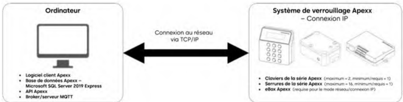
Figure 4 – Configuration d'un seul ordinateur - réseau via eBox (TCP/IP)
