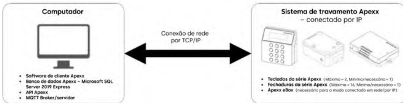
Figura 4 – Configuração de um único computador (rede via eBox [TCP/IP])
