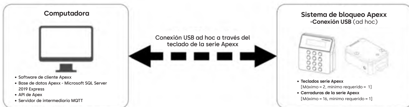
Figura 3: Configuración de un solo ordenador - Conexión USB ad hoc
