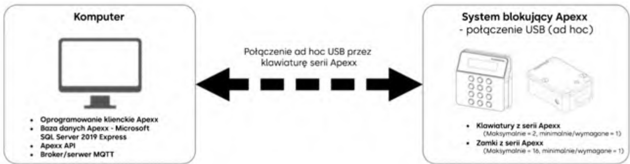
Rysunek 3 – Konfiguracja pojedynczego komputera - połączenie USB ad hoc
