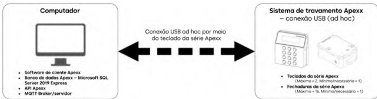
Figura 3 – Configuração de um único computador (conexão USB ad hoc)
