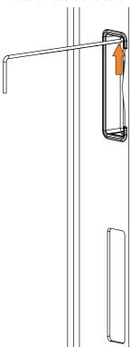
Demontagewerkzeug so lange vorsichtig nach unten drücken, bis sich der Stahlzargeneinsatz aus der Stahlzarge löst.
