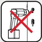
Bei Beschlagsmontage nicht durch das Schloss bohren. Sicherstellen das beim Bohren der Beschlagslöcher keine Späne in den Schlosskasten gelangen können, ansonst kann die Funktion des Schlosses nicht gewährleistet werden!
