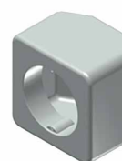
Konsola 1 z adapterem z tworzywa sztucznego w RAL 9006, szer./wys./gł. 94/94/65 mm z wycięciem \varnothing 65 mm, mocowana na bocznej barierze.
