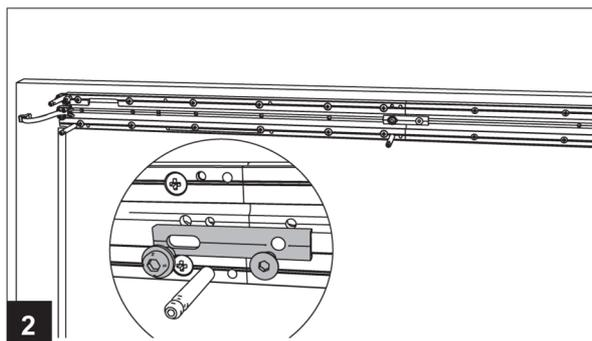
Высверлите два отверстия диаметром 5,5 мм в каждой из наружных канавок удлинителя монтажной пластины. Не затягивая, ввинтите резьбонарезной винт (с плоской цилиндрической головкой) в каждое из четырех отверстий (достаточно нескольких оборотов).
