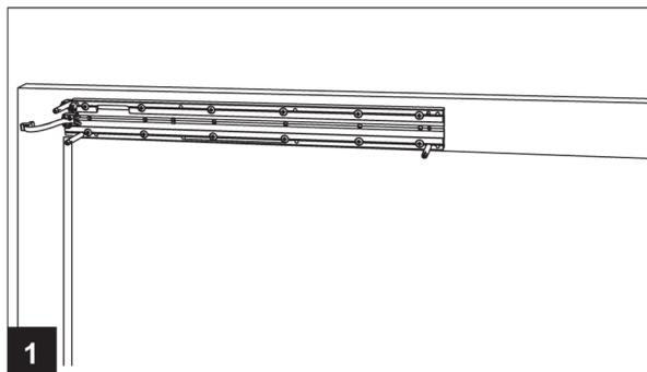
Удерживайте удлинитель монтажной пластины таким образом, чтобы он соприкасался с монтажной пластиной, и соедините обе части с помощью прилагаемого соединителя и двух винтов. Используйте по крайней мере два винта, чтобы закрепить удлинитель монтажной пластины на дверной коробке.
