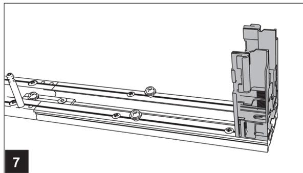
Слегка вверните два самореза для крепления кронштейна по центру (достаточно нескольких оборотов).
