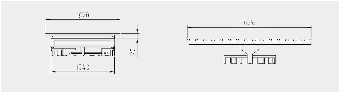
**Dach D2** – mit Trapezblechabdeckung, Dachrandprofil und Wasserablauf
