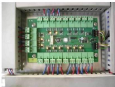
Модуль ввода "I2" к –X401 (IN1 расположен в правом нижнем углу)
