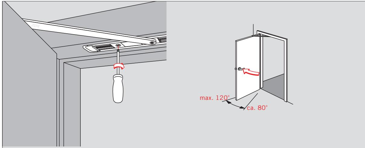
**D** Durch den Einsatz der Öffnungsbegrenzung soll verhindert werden, daß eine **normal** geöffnete Tür gegen angrenzende Wände stößt. Sie ist keine Überlastsicherung und ersetzt in vielen Anwendungsfällen nicht einen Türstopper. Öffnungsbegrenzung einstellbar zwischen 80° und max. 120°.
