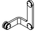
Befestigung mit Zylinderkopfschraube DIN 7984 M10x...,
