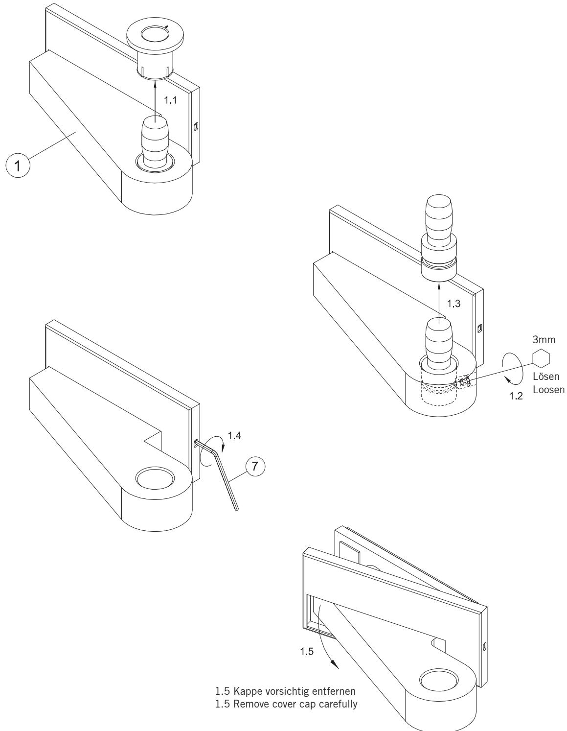
Oberer Beschlag zur Befestigung an Glas, Wand und Zarge
