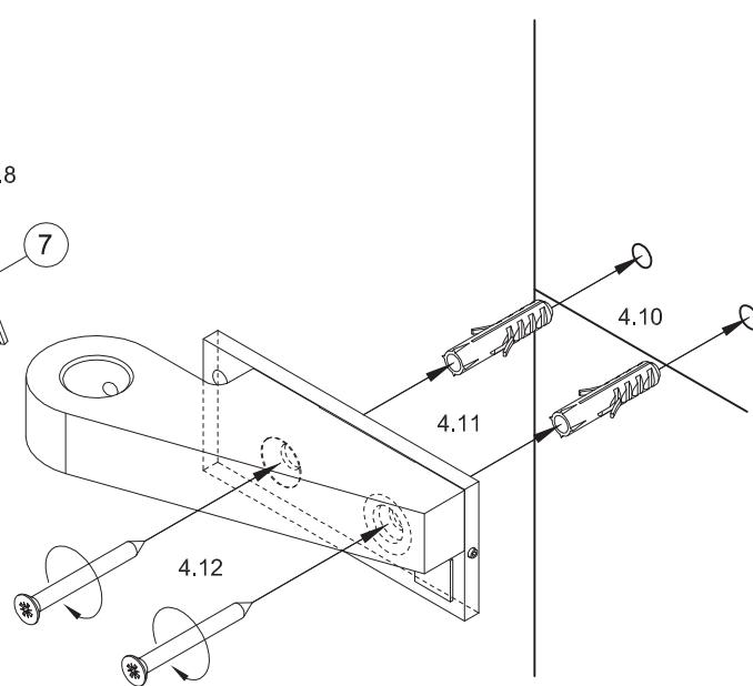
Oberer Beschlag zur Befestigung an Glas, Wand und Zarge
