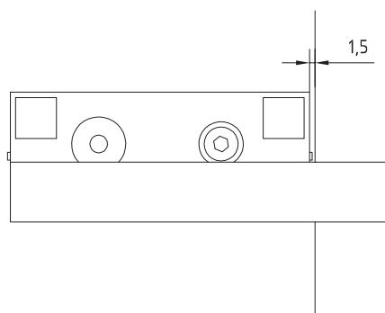
Oberer Beschlag zur Befestigung an Glas, Wand und Zarge
