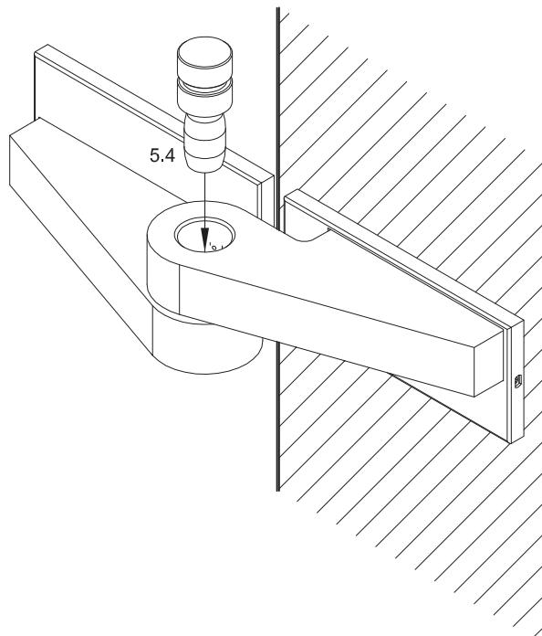
5.4 Der Bolzen muss mit etwas Kraft eingedrückt werden, um die Wulst in der Buchse zu überbrücken. Dieser dient zur Absturzsicherung des Beschlages bei evtl. Glasbruch.
