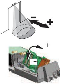
Réglage manuel de l'orientation  $-20^\circ \dots +20^\circ$  par incréments de  $5^\circ$
