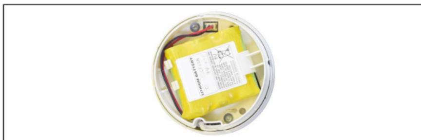
Fig. 5 Collegare e inserire il pacco batteria
