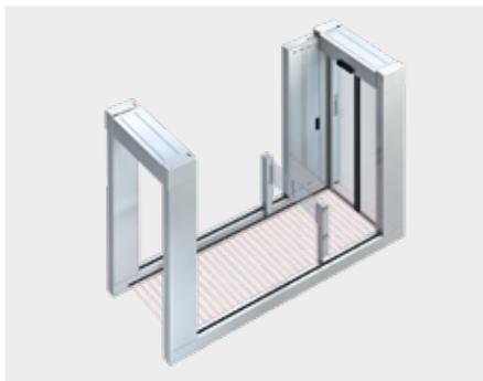
Horizontales Lichtgitter für Personensicherheit, Türöffnung und die Erkennung im Korridor hinterlassener Gegenstände ab 50 x 50 x 50 mm.
