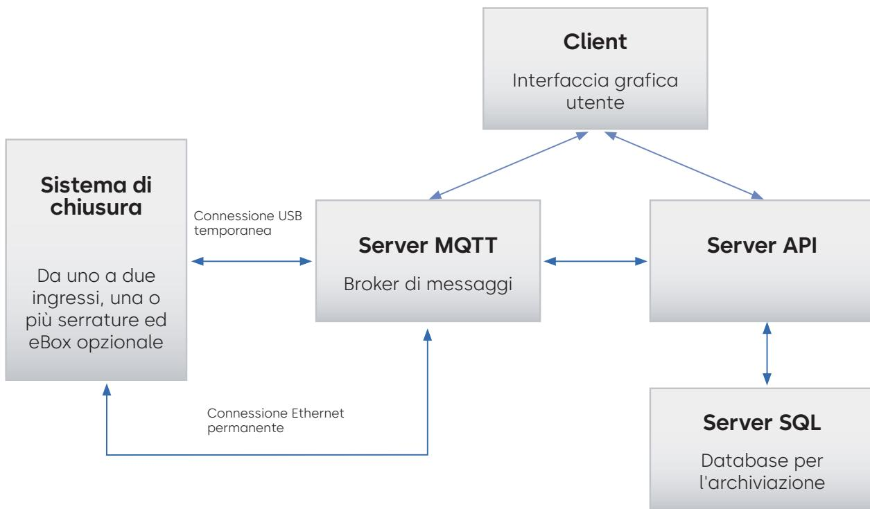
Esistono due possibili collegamenti tra il sistema di chiusura e il SW locale. Uno è il collegamento diretto via USB all'ingresso. Questa connessione deve essere abilitata da un utente autorizzato nel menu di selezione della serratura. La seconda connessione è dalla eBox via Ethernet al SW locale.
