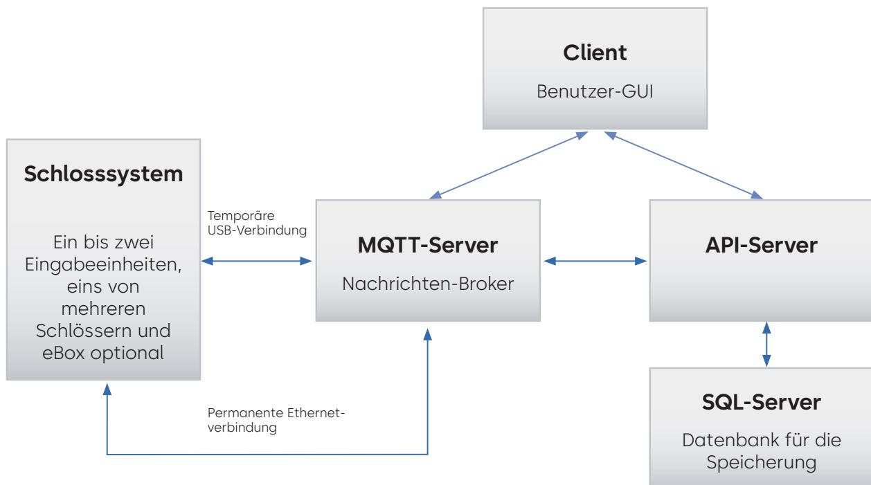
Es gibt zwei mögliche Verbindungen zwischen dem Schlosssystem und der lokalen SW. Eine davon ist die direkte Verbindung über USB zur Eingabeeinheit. Diese Verbindung muss von einem berechtigten Benutzer in der Menüauswahl des Schlosses aktiviert werden. Die zweite Verbindung verläuft von der eBox über Ethernet zur lokalen SW.
