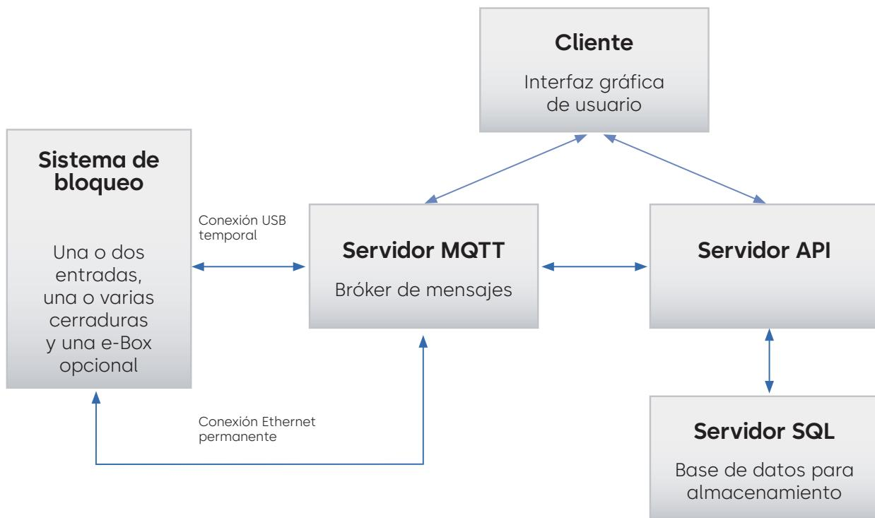
Hay dos posibilidades de conexión entre el sistema de bloqueo y el software local. Una es la conexión directa a la entrada por USB. Esta conexión debe ser habilitada por un usuario autorizado en el menú de selección de la cerradura. La segunda conexión va de la e-Box al software local a través de Ethernet.
