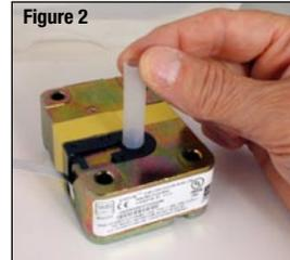
6. Glisser une extrémité du câble ruban dans le connecteur au fond du coffre de serrure. (Figure 3)
