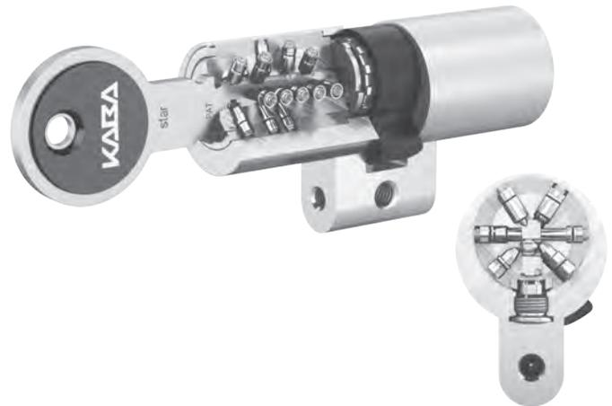
Il sistema di chiusura Kaba star cross basato sul Kaba star è un'aggiunta supplementare alla sicurezza. Un elemento mobile a forma di croce nella chiave aumenta la protezione contro la duplicazione illegale. Perché solo se l'elemento attivo nella chiave coincide con gli elementi di sicurezza nel cilindro la chiave Kaba star cross può aprire e chiudere meccanicamente il corrispondente cilindro.
