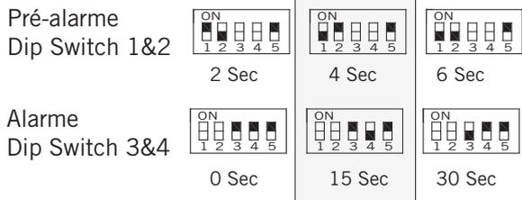
4 A la fin de la durée de l'alarme, le buzzer s'arrête, La LED passe au vert. Le relais "alarme" est désactivé, le relais "issue verrouillée" est activé.
