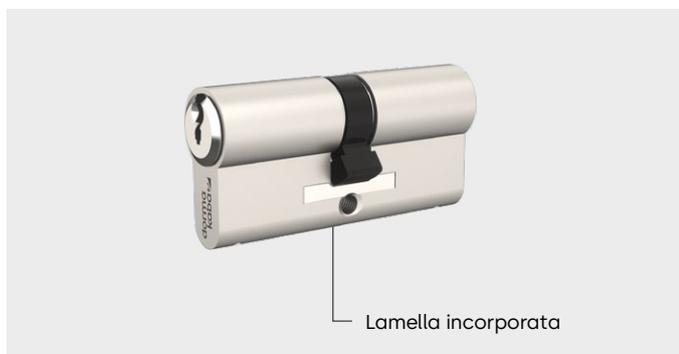
**Attacco dall'esterno? Massima resistenza dall'interno.** L'impiego di lamelle in acciaio temprato nel cilindro rafforza in modo efficace il ponte e garantisce una maggiore protezione antiestrazione, che soddisfa la classe di resistenza agli attacchi D della norma DIN EN 1303.
