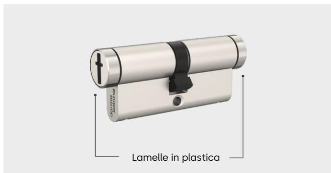
**C'è molta polvere nell'aria? Non nel cilindro.** Due lamelle di plastica girevoli e con molla poste nella parte anteriore del cilindro impediscono la penetrazione di polvere e spruzzi d'acqua. Grazie alla loro forma, consentono di infilare la chiave facilmente.
