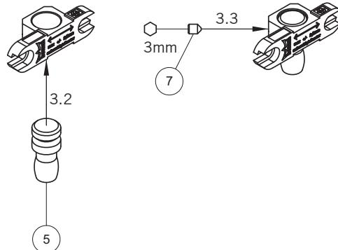
3.4 Der Einsatz muss mit etwas Kraft auf den Zapfen gedrückt werden, um die Wulst in der Buchse (PT 20) zu überbrücken. Diese dient zur Absturzsicherung des Beschlages bei evtl. Glasbruch
