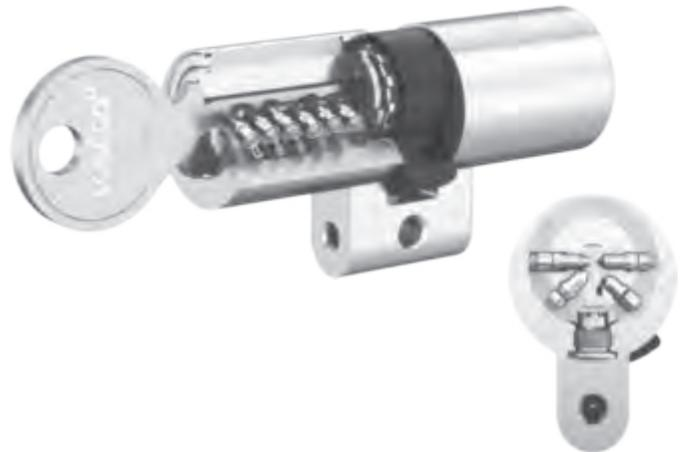
Kaba 20 est le système de fermeture standard pour les fermetures de série et les installations de fermeture enregistrées. La commande de clés supplémentaires est protégée par le dépôt d'une carte de sécurité. Les clés sont fabriquées avec un procédé de fraisage de précision étagé et piloté par ordinateur. Kaba 20 est un système de fermeture performant adapté aux immeubles d'habitation et aux bâtiments commerciaux.
