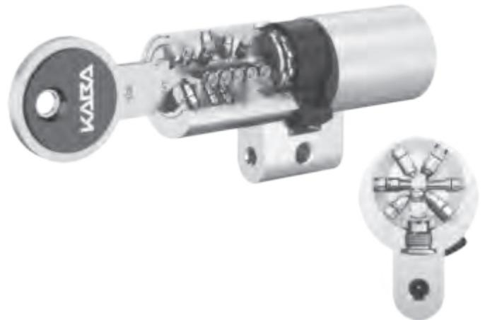
Le système de fermeture Kaba star cross basé sur Kaba star constitue un plus en matière de sécurité. L'élément cruciforme mobile dans la clé augmente la protection contre la duplication illégale. En effet, la clé Kaba star cross ne peut ouvrir et fermer le cylindre mécanique correspondant que si l'élément actif de la clé est conforme avec les éléments de sécurité présents dans le cylindre.
