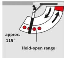
定位装置让门在左图所示定位范围内的任意点产生准确定位, 由于采用了滑槽臂, 定位装置不分左右手。
