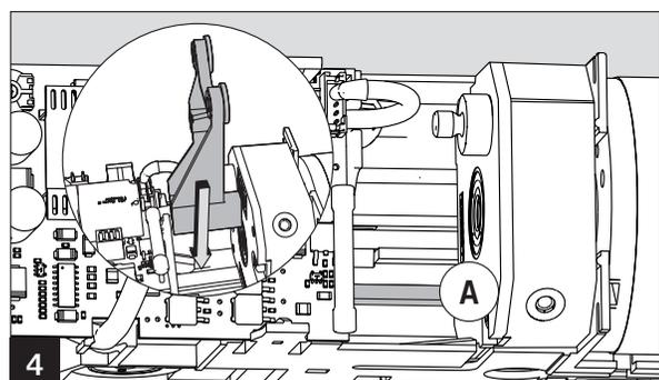
Öffnungsbolzen in die der Montageart entsprechenden Bohrung des Kupplungsstücks einschrauben.
