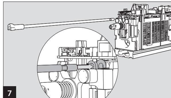
Mittels der Schlüsselflächen die Stange bis zum spürbaren Anschlag in das Kupplungsstück einschrauben.
