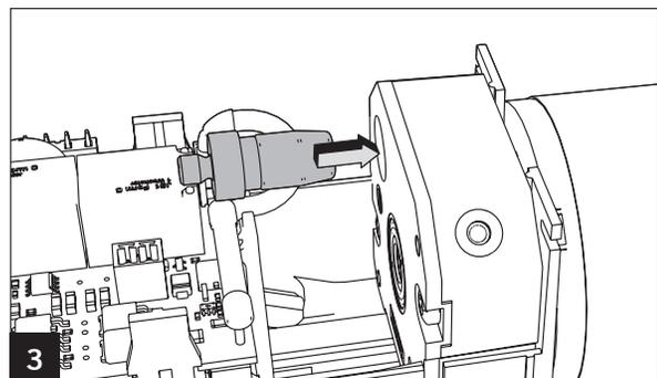
Kupplungsstück für den Gangflügel im Systemträger auf die Führung "A" setzen.
