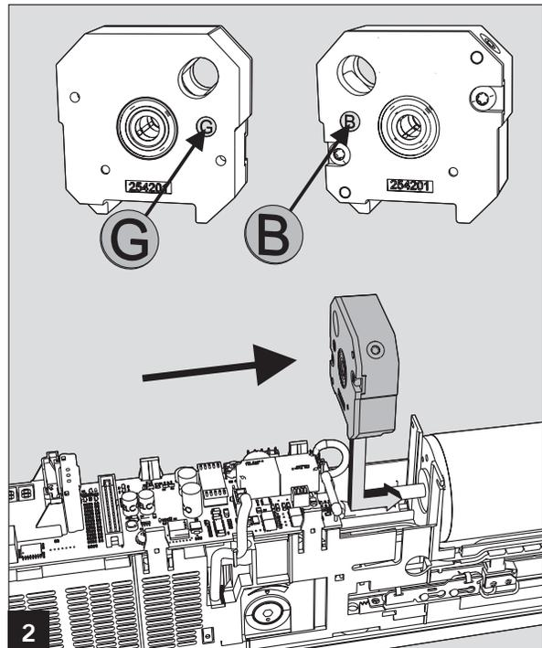
Öffnungsbolzen in die Öffnung der Bremse einsetzen.
