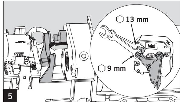
Rückstelleinheit stirnseitig am Systemträger verschrauben. Hierbei auf die korrekte Lage der Druckplatte "A" achten.
