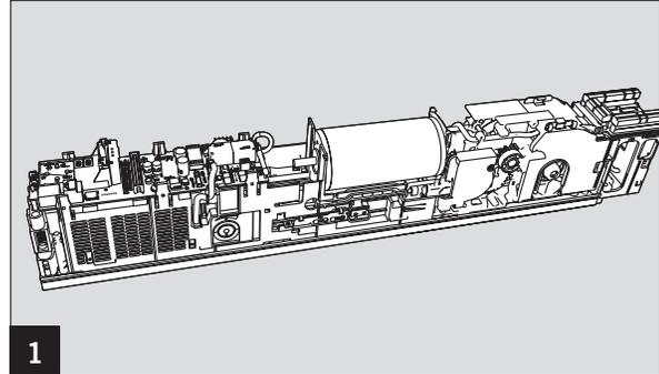
Bremse entsprechend der Montageart (Bandseite/ Bandgegenseite) vor der Motorwelle in den Systemträger einsetzen.
