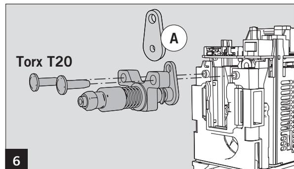
Stange für den Gangflügel (**GF**) stirnseitig zuerst in die freie Bohrung der Druckplatte, dann in die Führungen des Systemträgers einschieben.
