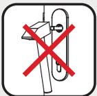
Der Drückerstift darf nicht mit Gewalt durch die Schlossnuss geschlagen werden, da es sonst zu Verformungen und Störungen an Funktionsteilen des Schlosses kommen kann.
