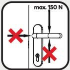
Das Fluchttürschloss der Serie 132/PA mit EÖ hält bei Blockierung der Paniknuss einem Drehmoment von maximal 15 Nm (das entspricht 150 N aufgebracht im Abstand von 100 mm von der Drückerlagerung) stand. Bei größeren Drehmomenten, kann es zu Deformationen der Schlosskinematik kommen!
