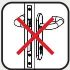
Riegel bei offener Tür nicht ausschließen (in verriegelter Stellung), da sonst bei Brandschutztüren die Selbstverriegelung nicht mehr gegeben ist und/oder beim Zuschlagen der Tür der Riegel verformt werden kann. Dadurch kann es zu erheblichen Funktionsstörungen im Schloss kommen!
