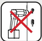
Bei Beschlagsmontage nicht durch das Schloss bohren.
