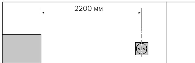
Рис. 4 Монтаж с розеткой с заземляющим контактом
